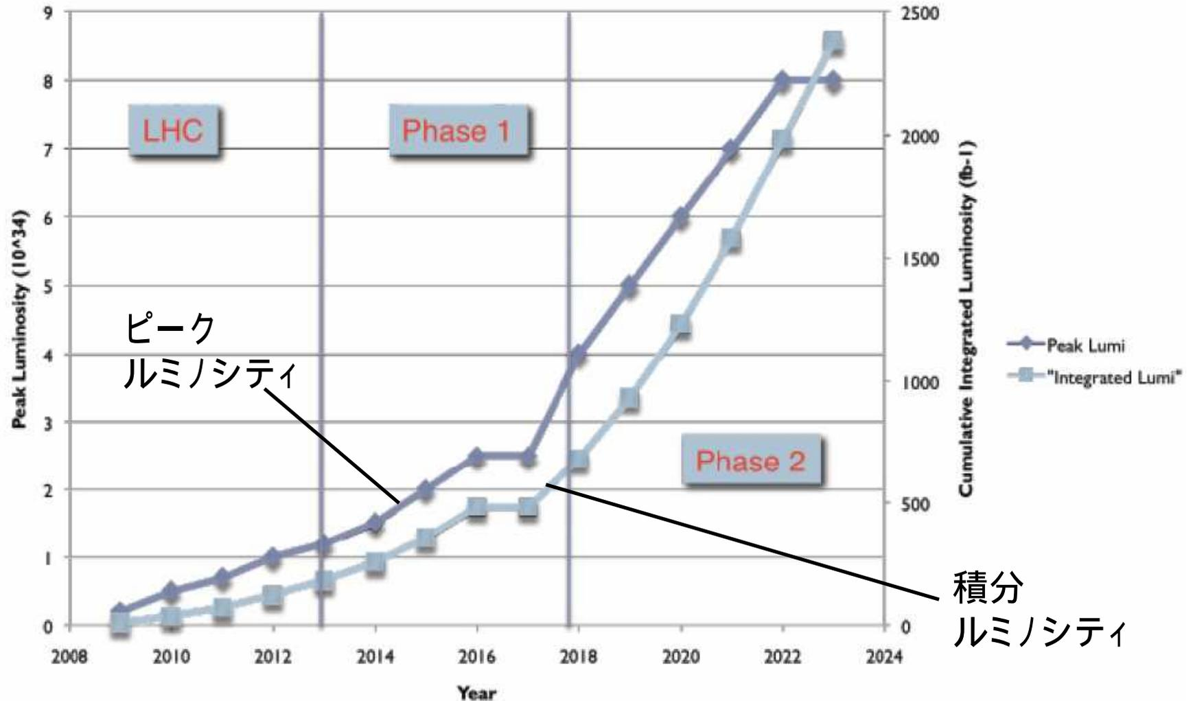
(現行LHCで)2012年までにルミノシティ  $10^{34}[\text{cm}^{-2}\text{sec}^{-1}]$  を達成する
