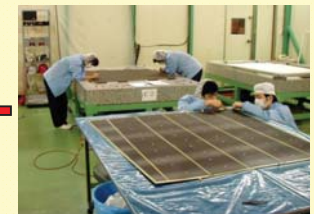
検査、清掃、高電圧検査
