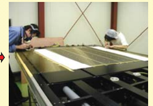
ワイヤーの半田付けと洗浄作業
