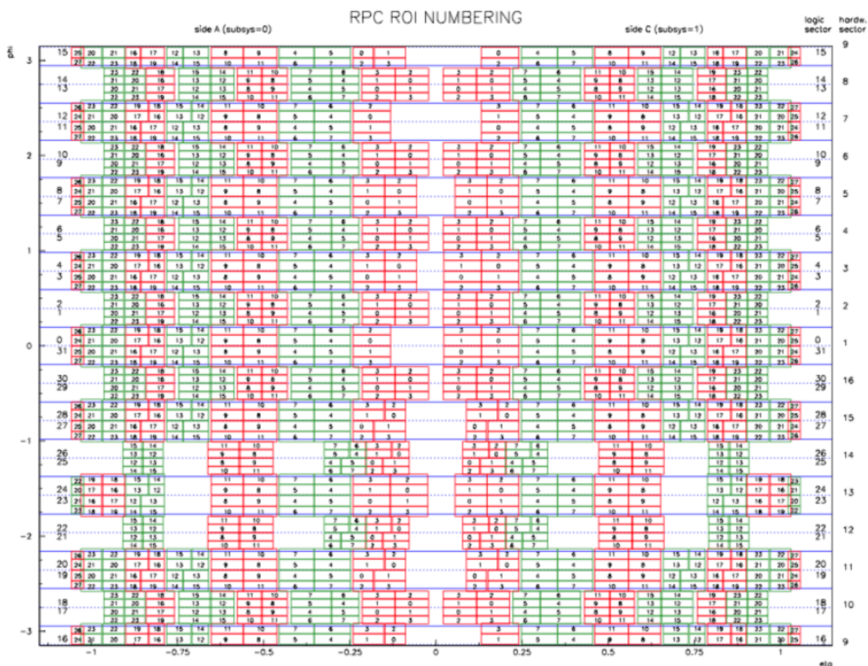
図 6.4: バレル部における RPC RoI 番号。RPC を \phi = \pi で展開しており、横軸は \eta 、縦軸は \phi を表す。図中の小さな長方形は RoI、トリガーセクターごとに色分けされた RoI の集合は Pad を表しており、各 RoI にはそれぞれ番号が付けられている。
