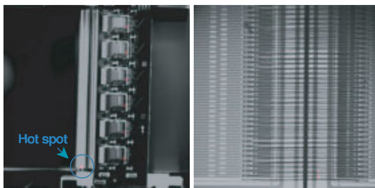
図 17: 赤外線カメラによる、マイクロディスチャージの写真 赤く光っているところがホットスポットである。右は左の丸の部分拡大したもの。
