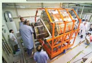
2006年2月 CERNにてKEKの設計製作による組み立て装置を用い、TRT検出器内にSCT検出器を組み込むことに成功
