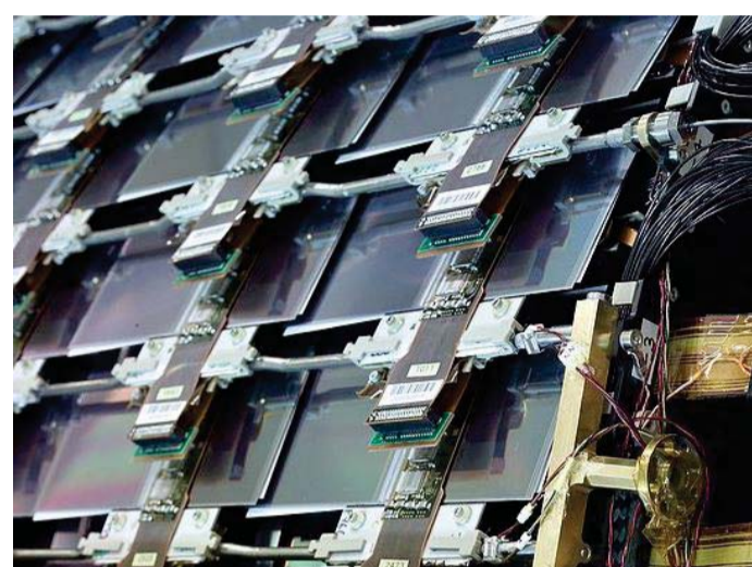
組立後のバレルモジュール層 冷却用C 3 F 8 相流が4mmφパイプを流れてセンサーを0°C以下に保ち放射線に強くする。
