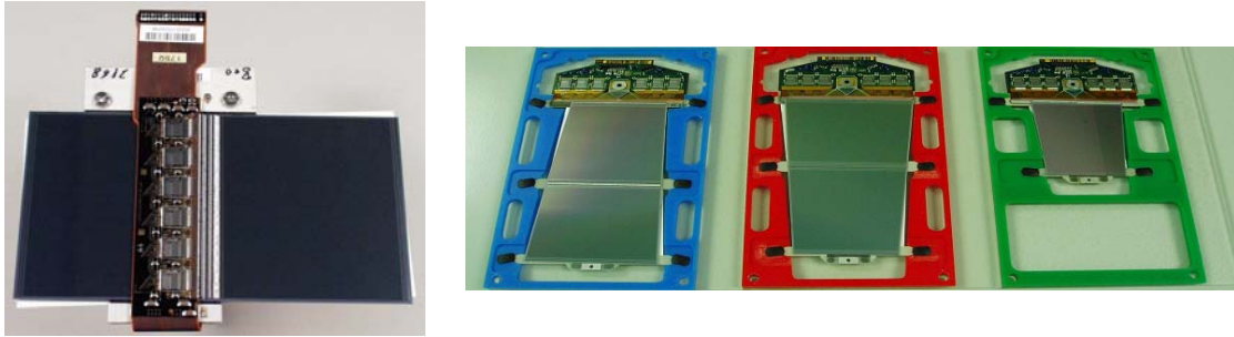
図 1.10: SCT パレルモジュール, エンドキャップモジュールの写真。(左) パレル SCT モジュール。写真横方向にストリップが走っている。(右) エンドキャップ SCT モジュール。左から Outer, Middle, Inner。写真縦方向にストリップが走っている。
