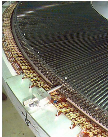
図 1.11: TRT 検出器 . (左) バレル部の 4 分の 1 の写真 . 内側から 3 層 , また動径方向に各 32 モジュールに分かれている . (右) エンドキャップ部の写真 . 放射状にチューブがすき間なく並べられている .
