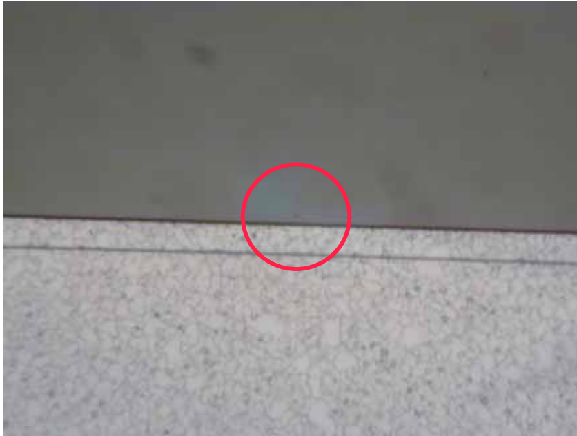
図 5.17: “ バイアスリングでの発光 ”に分類されたモジュール ID 864 の画像。赤外線撮影した際にスポットが光っていた場所は、図中に書き込まれた赤い円の中心に位置する。I-V 曲線と暗電流-経過時間の関係を図(5.18)及び図(5.19)に示す。
