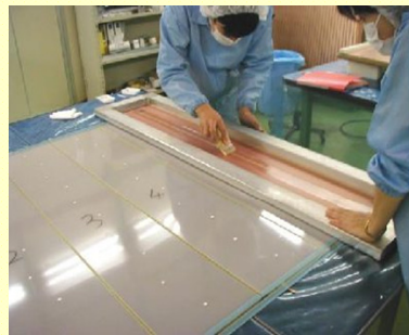
エポキシ接着剤の塗布作業
