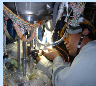
2005年12月 コントロールデューワーとの接続作業
