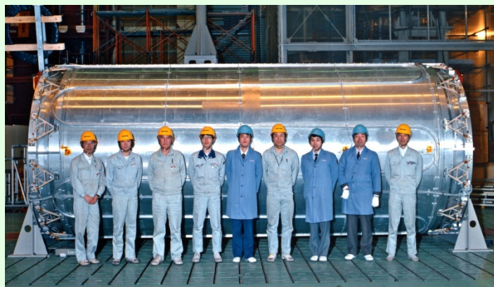
1999年12月 東芝・京浜工場にて24個のサポートでコイルをクライオスタット内筒へ据え付け
