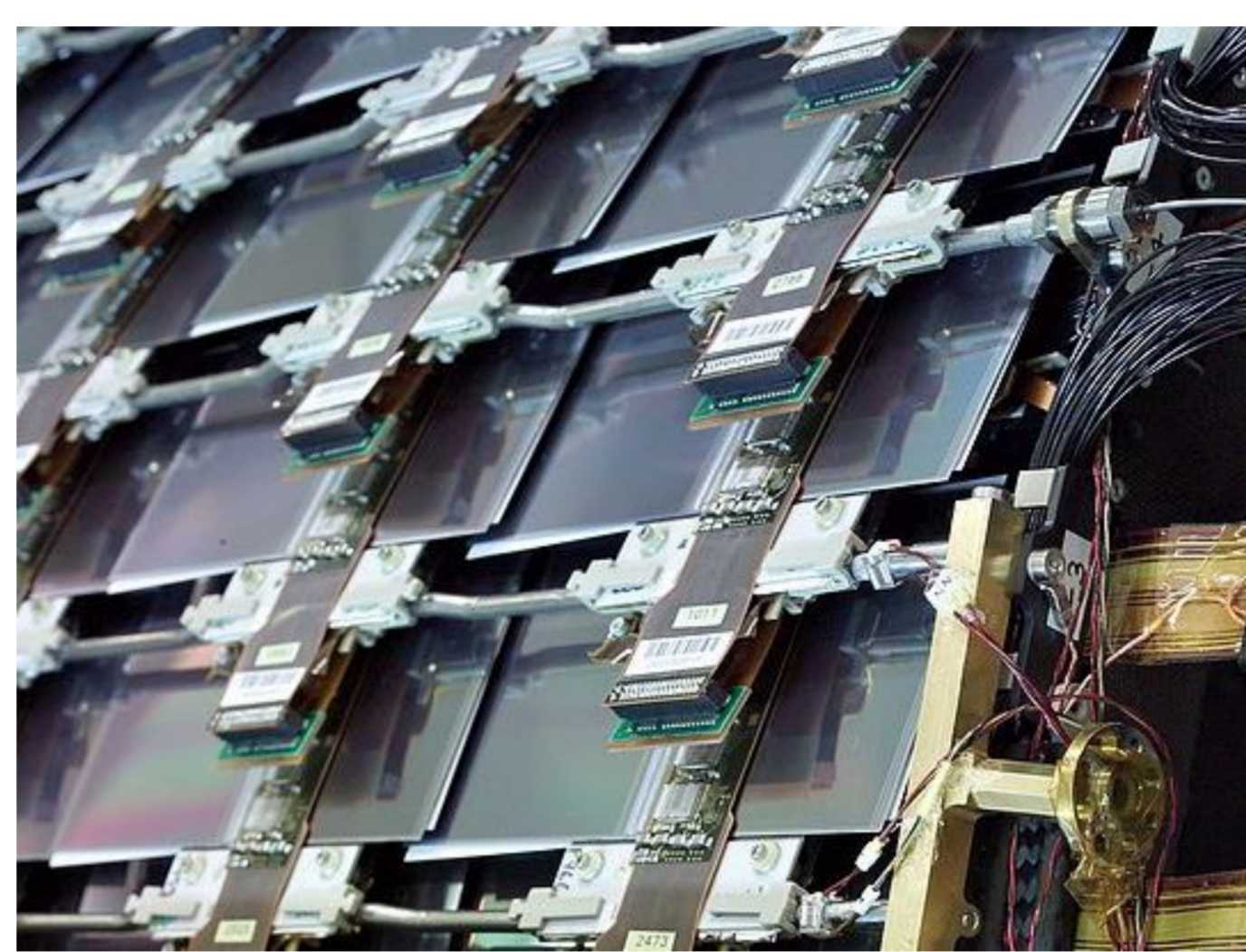
組立後のバレルモジュール層 冷却用 C_3F_8 相流が4mmφパイプを流れてセンサーを 0^\circ\text{C} 以下に保ち放射線に強くする。
