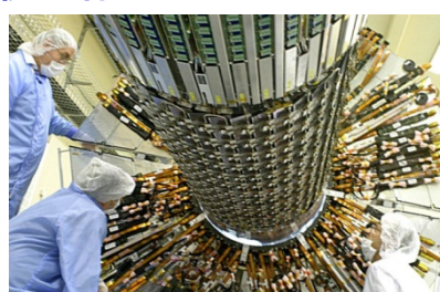
内部飛跡検出器: 荷電粒子の飛跡を17μmの精度で捕えて運動量を測定する。写真はCERN地上での組み込み作業(2006年)
