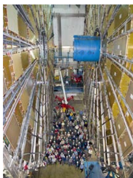
シンギャップチェンバー: 前後におかれたワイヤーチェンバーで高横運動量のミュオンをトリガーする。写真は地下で据付を完了したところ(2007年)
