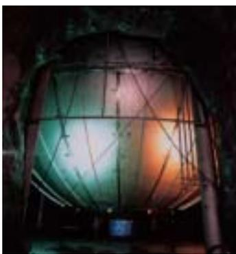
**KamLand** est un détecteur le plus grand d'antineutrinos de basse énergie, équipé de 1.000 tonnes de scintillateur liquide. Il a commencé l'opération en 2001 et déjà trouvé la disparition des anti-neutrinos émis par les réacteurs nucléaires commerciaux, cela supporte l'oscillation des neutrinos.
