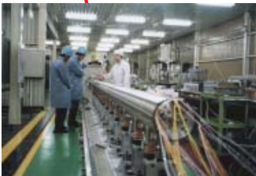
Le KEK a développé et fabriqué 18 supraconducteurs quadripôles pour focaliser le faisceau aux points d'interactions de l'ALTA et le CMS.
