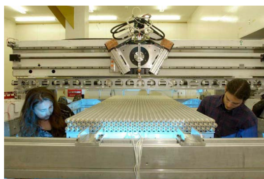
ミュオンドリフト検出器 :直径30mmのドリフトチューブでミュオンの飛跡を測る。3気圧。354,144チャンネル。他にCSC型が30,720チャンネルある。
