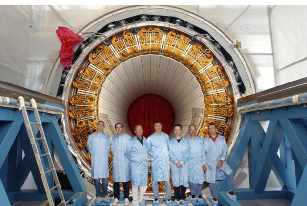
液体アルゴン電磁カロリメーター :ドリフト間隔2mmのアコーデオン型。吸収体は鉛。バレル部: 109,568、端部: 63,744チャンネル。
