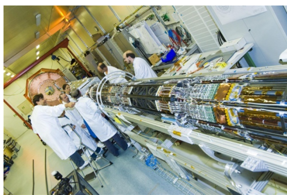
シリコンピクセル検出器 :ピクセルサイズ 50 \times 400 \mu\text{m}^2 。80,363,520チャンネル。
