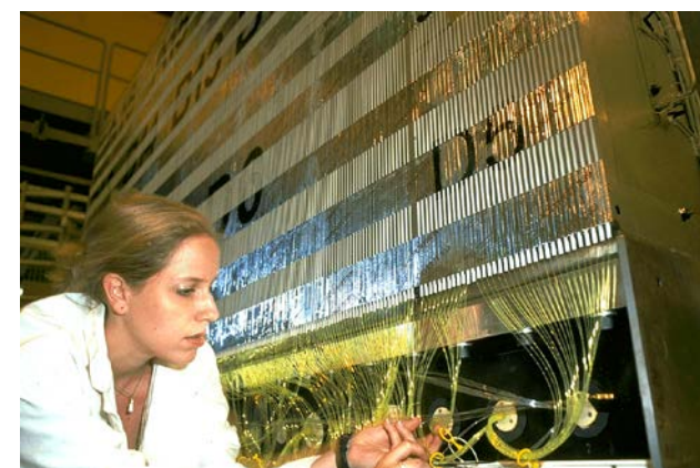
シンチレーションハドロンカロリメーター :タイル型シンチレーターの光を波長変換光ファイバーで集める。吸収体は鉄。9,852チャンネル。
