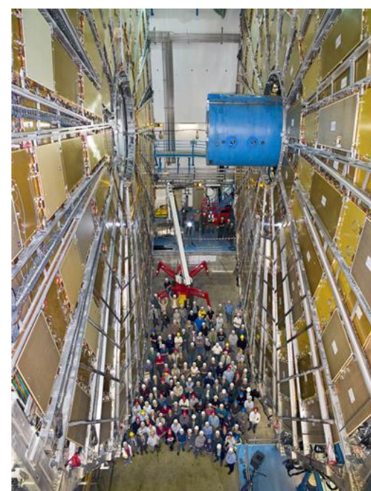
ミュオントリガー検出器 :端部はTGC型、中央部はRPC型チェンバーで高横運動量のミュオンをトリガーする。端部: 318,112チャンネル、中央部: 373,000チャンネル。
