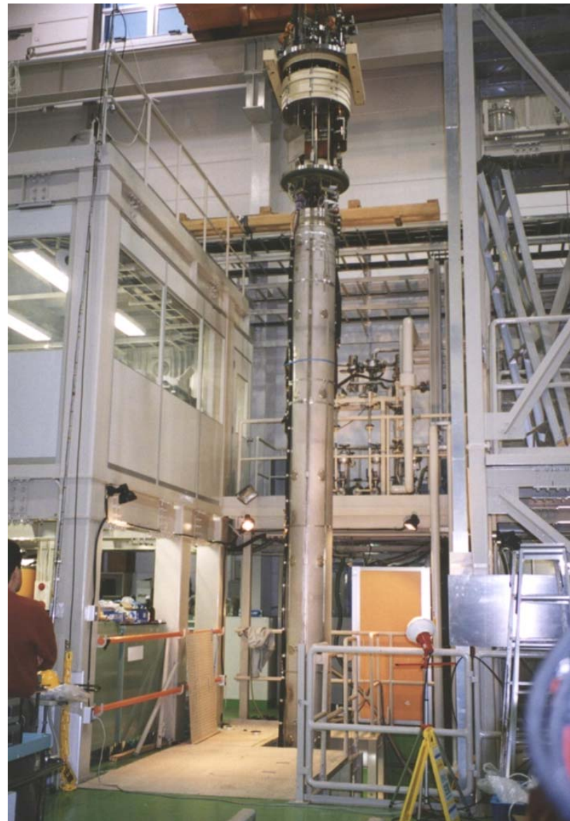
KEKでの1.9Kでの励磁・磁場測定
