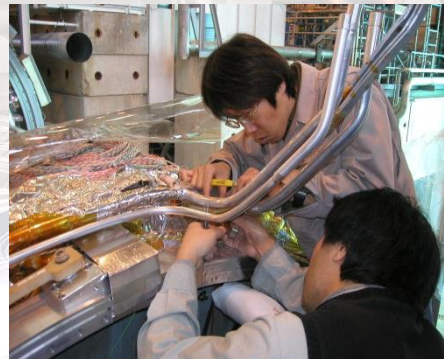
2004.3 液体アルゴンカロリメーターへの挿入作業。
