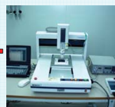
自動3軸塗布装置によるセンサーとベースボード間の接着作業
