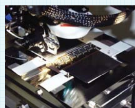
マシンによる自動ワイヤボンディング 1モジュールあたり5000ボンディング (浜松トニクス/セイコープレジジョン)
