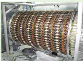
2004年5月 KEK開発のロボットを使って4シリンダー上へ全モジュールが搭載された (オックスフォード大学)
