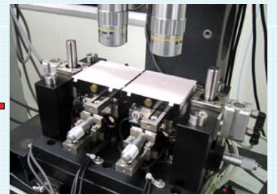
センサーの位置合わせのための顕微鏡装置 (KEKで開発)
