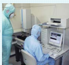
組み立てで精度測定のための三次元測定器 (浜松トニクス/セイコープレジジョン)
